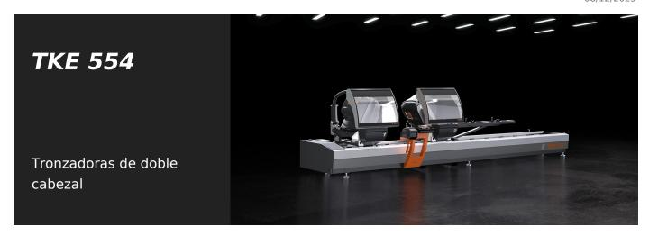
Tronzadora de doble cabezal con 3 ejes controlados con movimiento automático del cabezal móvil y gestión electrónica de todos los ángulos comprendidos en el intervalo 22°30' externos y 45° internos. El avance de los dos discos de 550 mm se efectúa mediante cilindros oleoneumáticos.
