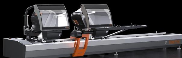
Tronzadora de doble cabezal con 3 ejes controlados con movimiento automático del cabezal móvil y gestión electrónica de todos los ángulos comprendidos en el intervalo 22°30' externos y 45° internos. El avance de los dos discos de 550 mm se efectúa mediante cilindros oleoneumáticos.
