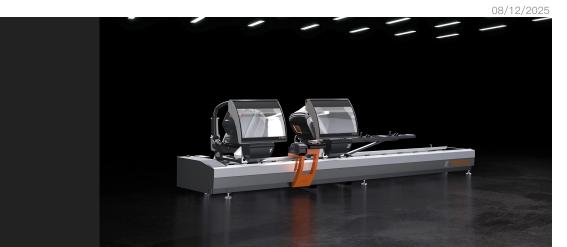
3 受控轴的双头切割机带有活动切割头自动移动装置、可以对向外 22°30′到向内 45°范围内的所有角度进行电子化处理。两个 550 mm 的刀片进给由气动油压缸驱动。
