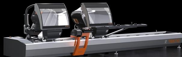
3 受控轴的双头切割机带有活动切割头自动移动装置、可以对向外  $22^{\circ}30'$  到向内  $45^{\circ}$  范围内的所有角度进行电子化处理。两个 550 mm 的刀片进给由气动油压缸驱动。
