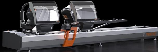
3 受控轴的双头切割机带有活动切割头自动移动装置、可以对向外 22°30' 到向内 45° 范围内的所有角度进行电子化处理。两个 550 mm 的刀片进给由气动油压缸驱动。
