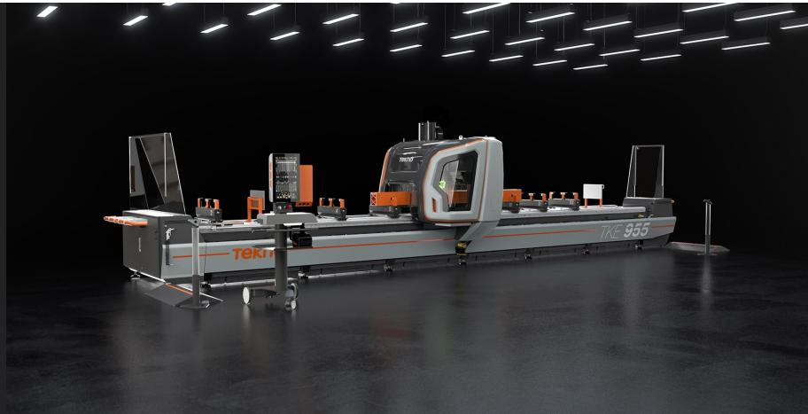
带移动门的 5 轴 CNC 加工中心，用于在厚度 10 mm 及以下的铝、轻合金、PVC 及厚度 2 mm 及以下的钢材质的型材或板材上执行从 -90° 至
