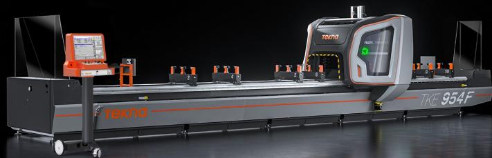
带移动门的 4 轴 CNC 加工中心，用于在厚度 10 mm 及以下的铝、轻合金、PVC 及厚度 2 mm 及以下的钢材质的型材或板材上执行从 -90°至 +90°之间任意角度的钻孔、铣削和螺纹加工。机器的移动部分由移动门构成，该移动门配备了高精度齿条龙门架的双重机动装置。由高科技聚
