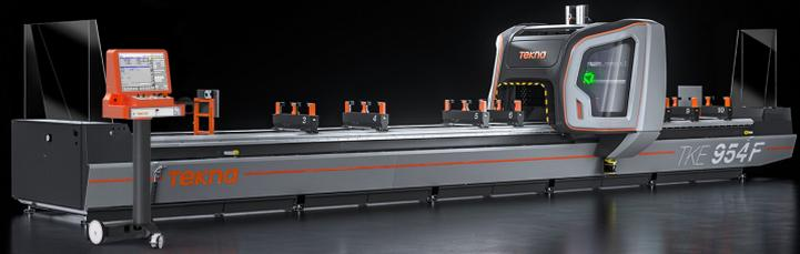
带移动门的 4 轴 CNC 加工中心，用于在厚度 10 mm 及以下的铝、轻合金、PVC 及厚度 2 mm 及以下的钢材质的型材或板材上执行从 -90°至
