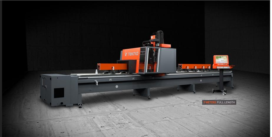
带移动门的 4 轴 CNC 加工中心、用于在厚度 10 mm 及以下的铝、轻合金、PVC 及厚度 2 mm 及以下的钢材质的型材或板材上执行从 -90°至
