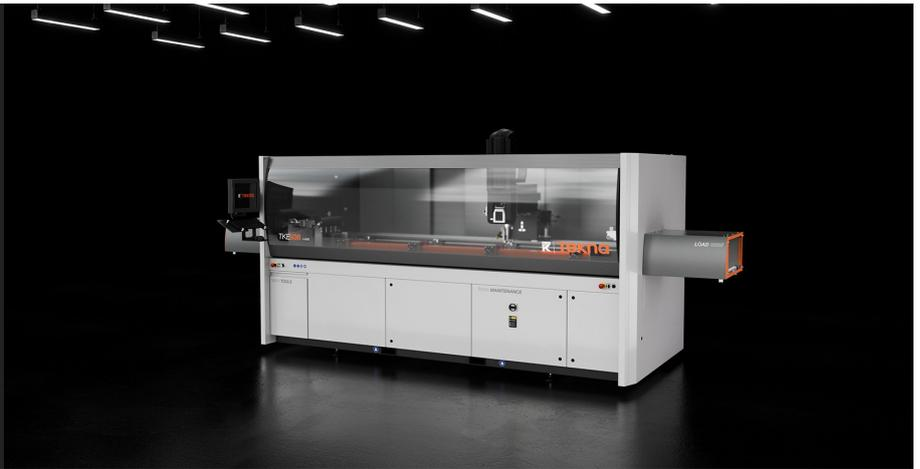
带有 4 个控制轴的数控加工中心，刀具可以自动旋转，从而对工件的 3 个面进行加工。加工中心专门用于加工最大厚度 2 毫米的铝、PVC、一般轻合金的棒材或工件。配有一个 9 刀位的手动刀具库，可以在保护舱两侧增加一个或两个各 4 刀位的自动刀具库。型材通过一个位于左侧的气动挡块进行定位，通过 4 个 X 轴自动定位的坚固虎钳进行夹持。可选择在右侧安装第二个气动挡块，以允许对两倍于加工长度范围的棒材进行超大尺寸加工。所有数控轴都是绝对轴、在机床重新启动时不需要重新设置。加工中心还配有一个活动工作台，方便工件装卸，大大增加了可加工截面。
