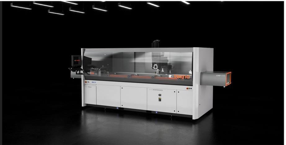
带有 4 个控制轴的数控加工中心，刀具可以自动旋转，从而对工件的 3 个面进行加工。加工中心专门用于加工最大厚度 2 毫米的铝、PVC、一般轻合金的棒材或工件。配有一个 9 刀位的手动刀具库，可以在保护舱两侧增加一个或两个各 4 刀位的自动刀具库。型材通过一个位于左侧的气动挡块进行定位，通过 4 个 X 轴自动定位的坚固虎钳进行夹持。可选择在右侧安装第二个气动挡块，以允许对两倍于加工长度范围的棒材进行超大尺寸加工。所有数控轴都是绝对轴、在机床重新启动时不需要重新设置。加工中心还配有一个活动工作台，方便工件装卸，大大增加了可加工截面。
