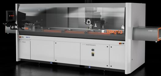
带有 4 个控制轴的数控加工中心，刀具可以自动旋转，从而对工件的 3 个面进行加工。加工中心专门用于加工最大厚度 2 毫米的铝、PVC、一般轻合金的棒材或工件。配有一个 9 刀位的手动刀具库，可以在保护舱两侧增加一个或两个各 4 刀位的自动刀具库。型材通过一个位于左侧的气动挡块进行定位，通过 4 轴自动定位的坚固虎钳进行夹持。可选择在右侧安装第二个气动挡块，以允许对两倍于加工长度范围的棒材进行超大尺寸加工。所有数控轴都是绝对轴、在机床重新启动时不需要重新设置。加工中心还配有一个活动工作台，方便工件装卸，大大增加了可加工截面。
