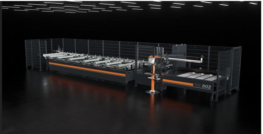
半自动切割中心、配有 CNC 控制的正面刀片、3 个被控制的轴、适合于切割铝合金、PVC 和普通轻合金型材。能够自动进行预设、优化的切割程序。在型材的两个断面可以进行倒角切割。此机器用于 45° 至 135° 或 22°30' 至 157°30' 角的切割。棒材自动装载装置和对侧的自动卸料仓可以与垂直或水平钻床配套、来进行特殊自动加工。
