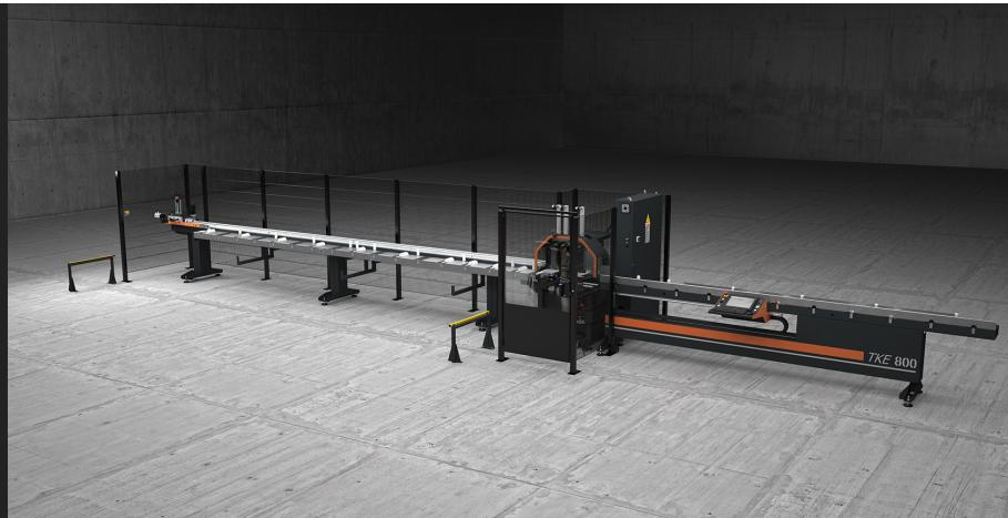
半自动版本的切割中心有 2 个控制轴、在机床的相对两侧进行手动的装卸料、正面数控刀片专门用于切割铝、PVC 和一般轻合金型材、能够自动进行预设定、优化的切割清单。设计用于在 45° 至 135° 或 22°30' 至 157°30' 的角度范围内进行切割。可以与垂直或水平钻孔单元配套、来进行特殊自动加工。
