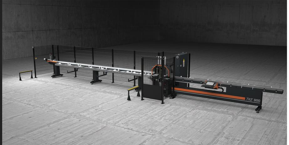
半自动版本的切割中心有 2 个控制轴、在机床的相对两侧进行手动的装卸料、正面数控刀片专门用于切割铝、PVC 和一般轻合金型材、能够自动进行预设、优化的切割清单。设计用于在  $45^{\circ}$  至  $135^{\circ}$  或  $22^{\circ}30'$  至  $157^{\circ}30'$  的角度范围内进行切割。可以与垂直或水平钻孔单元配套、来进行特殊自动加工。
