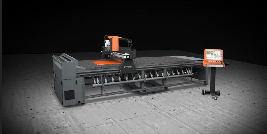
带有 3 个控制轴的数控加工中心，夹持系统由透气台面组成，可对面板和板材进行真空夹持；在加工厚度较小的部件时，这种解决方案特别有效，因为传统的虎钳系统难以夹持这类部件。加工中心配备了一系列的阀门，可以激活或关闭工作台的不同区域，并将吸力集中在某一特定区域，从而优化小尺寸元件的夹持。可以对复合板、铝和钢面板和板材进行插补钻铣加工。为生成机床引导程序，Tekna 提供了一些用户友好型软件，无论是专业数控程序员，还是完全没有经验的人都可以使用；只需几个小时的教学，客户就可以通过图形编程获得使用加工中心的必要知识。Tekna 提出的软件解决方案以客户的实际需要为基础，经过精心设计，保证了极高的易用性，从而减少管理的时间和成本。
