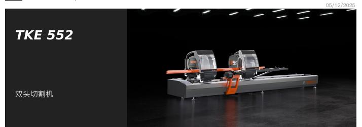
电子双头切割机配有数控控制的移动切割头无刷电动机自动移动装置。在两个固定位置上通过气动装置倾斜切割单元、角度范围 90°至 22°30′(外侧)、或者采用选配的中间角度机械调节系统。气动油压刀片进给。
