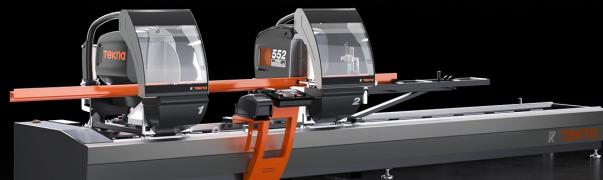
电子双头切割机配有数控控制的移动切割头无刷电动机自动移动装置。在两个固定位置上通过气动装置倾斜切割单元、角度范围 90°至 22°30' (外侧) 、或者采用选配的中间角度机械调节系统。气动油压刀片进给。
