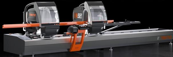
电子双头切割机配有数控控制的移动切割头无刷电动机自动移动装置。在两个固定位置上通过气动装置倾斜切割单元、角度范围 90°至 22°30'（外侧）、或者采用选配的中间角度机械调节系统。气动油压刀片进给。
