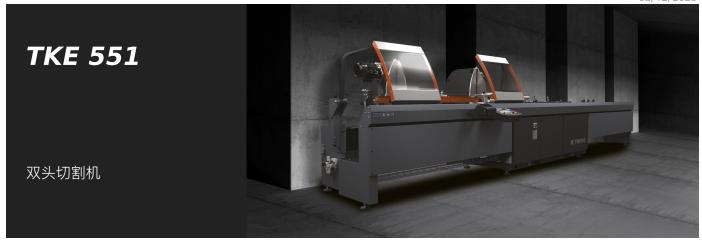
电子双头切割机配有数控控制的移动切割头无刷电动机自动移动装置。切割单元的气动倾斜度从 90° 到 22°30′ (外角) 、配有中间角度机械调节系统。气动油压刀片进给装置。
