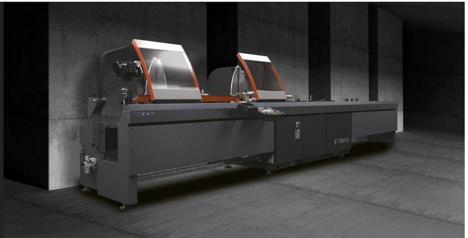
电子双头切割机配有数控控制的移动切割头无刷电动机自动移动装置。切割单元的气动倾斜度从 90° 到 22°30'（外角）、配有中间角度机械调节系统。气动油压刀片进给装置。
