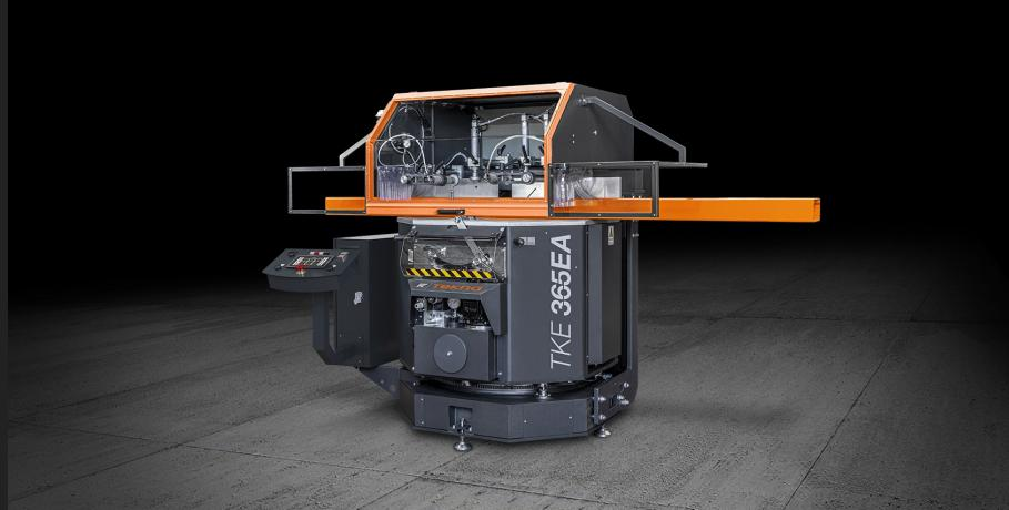
上升式单头切割机、带有无刷电机驱动的垂直轴数控自动旋转装置、水平轴还可以通过液压控制同时实现翻转。垂直轴上的切割角度为 90° 至 22°30' (左右两侧) 、水平轴上为 90° 至 35° (仅右侧) 。
