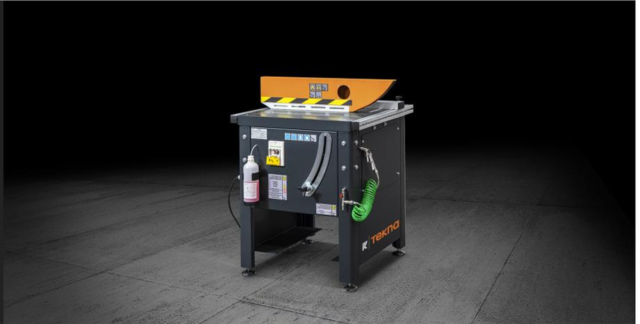
带有上升刀片出口的单头修剪机，用于挤压型材和平面铝板。特别坚固的结构使其能够进行精确切割，使型材面完全平行。修边机的设计还可以安装支撑辊筒输送机，增加了多功能性。刀片保护装置的设计和制造是为了在最佳安全条件下进行加工。
