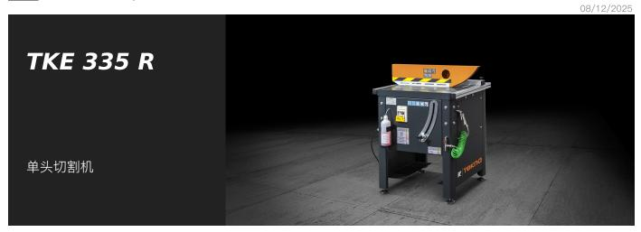
带有上升刀片出口的单头修剪机,用于挤压型材和平面铝板。特别坚固的结构使其能够进行精确切割,使型材面完全平行。修边机的设计还可 以安装支撑辊筒输送机,增加了多功能性。刀片保护装置的设计和制造是为了在最佳安全条件下进行加工。
