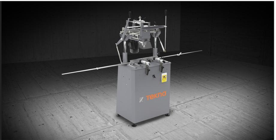
手动控制的单头受电弓，高度行程范围宽，可以通过手柄或间接杠杆平移切割头。可以在不转动工件的情况下进行通体式加工。手动控制探头
