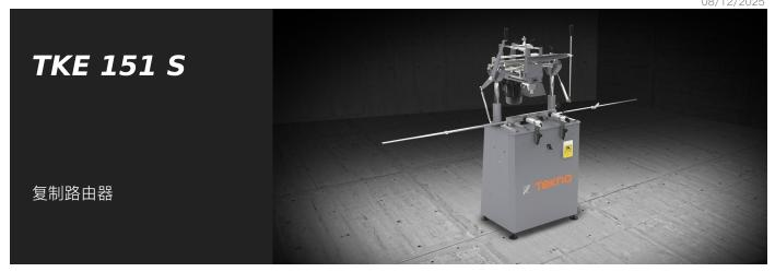
手动控制的单头受电弓,高度行程范围宽,可以通过手柄或间接杠杆平移切割头。可以在不转动工件的情况下进行通体式加工。手动控制探头
