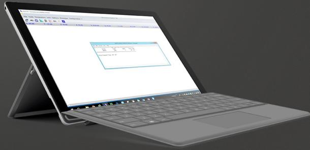
Time-X 是作为 CAMplus 套件的一部分提供的时间预测工具，用于提前计算工件的加工时间。对于加工预切割工件的机床，Time-X 将预估工件或装载在加工区的工件的加工时间。对于加工棒材的机床，Time-X 将预估每一根棒材的加工时间。
