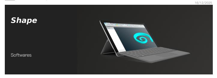
Shape是CAMplus的一个附加模块,通过这个软件,可以自由创建任何形状的图形,自由组成线条、弧线、孔洞。可以导入DXF格式的图形。由于可以三维显示,可以更好地理解具有非恒定深度的图形。通过使用Shape,原本需要通过合成"标准"图形才能实现的加工操作变得更加快捷。
