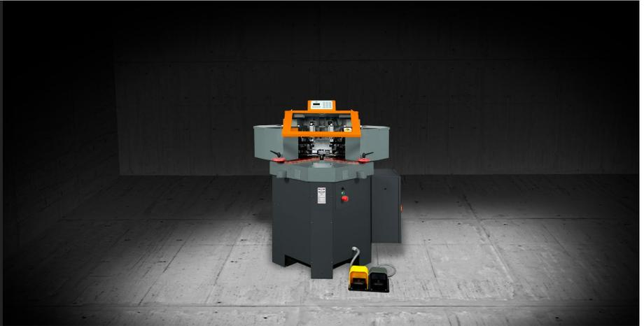
此机床拥有两个特殊操作头、上面配备了可以调节到所有倒角位置的 2 个倒角刀。倒角刀可以在 Y 轴（沿型材）、Z 轴（上下）和 X 轴（沿倒角方向）上移动并调整。无论加工何种类型的型材、这样的条件都可以避免在机床上更换刀具。这样就可以减少安置的时间和成本。
