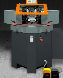
此机床拥有两个特殊操作头、上面配备了可以调节到所有倒角位置的 2 个倒角刀。倒角刀可以在 Y 轴（沿型材）、Z 轴（上下）和 X 轴（沿倒角方向）上移动并调整。无论加工何种类型的型材、这样的条件都可以避免在机床上更换刀具。这样就可以减少安置的时间和成本。
