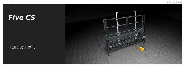
铝制窗框的测试台。可以再现窗框的使用条件:通过一个可调节的虎钳系统在窗框的整个高度对其进行夹持,将窗板插入窗框内,安装玻璃, 并进行最后的测试。辊筒输送机允许操作员完全自主地装卸重型窗框。
