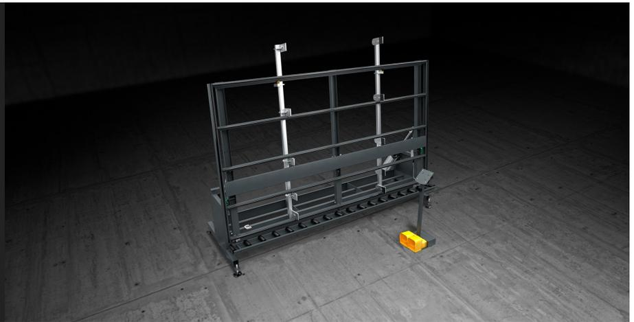
铝制窗框的测试台。可以再现窗框的使用条件：通过一个可调节的虎钳系统在窗框的整个高度对其进行夹持，将窗板插入窗框内，安装玻璃，并进行最后的测试。辊筒输送机允许操作员完全自主地装卸重型窗框。
