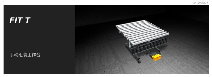
用于窗板和窗框组装的工作台。加工台面可从 0°(水平) 到 85°范围内倾斜。在软质的 PVC 支撑面(用于组装阶段)和抗摩擦的硬质 PVC 支撑面(用于搬运阶段)之间有气动交换装置。辊筒输送机可以独立于加工台,可手动倾斜,高度可调(从 170 到 460毫米)。工作台的高度可在 895 至 965 毫米之间调整,支脚设有地面固定孔。
