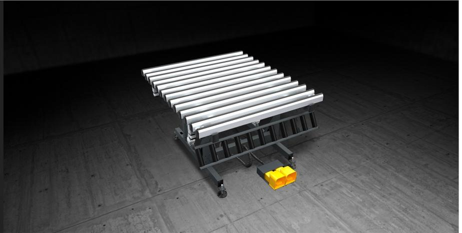
用于窗板和窗框组装的工作台。加工台面可从 0°（水平）到 85° 范围内倾斜。在软质的 PVC 支撑面（用于组装阶段）和抗摩擦的硬质 PVC 支撑面（用于搬运阶段）之间有气动交换装置。辊筒输送机可以独立于加工台，可手动倾斜，高度可调（从 170 到 460 毫米）。工作台的高度可在 895 至 965 毫米之间调整，支脚设有地面固定孔。
