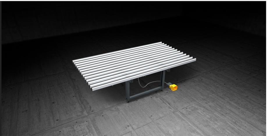
用于窗板和窗框组装的工作台。水平工作台在软质的 PVC 支撑面（用于组装阶段）和抗摩擦的硬质 PVC 支撑面（用于搬运阶段）之间有气动交换装置。工作台的高度可在 895 至 965 毫米之间调整，支脚设有地面固定孔。
