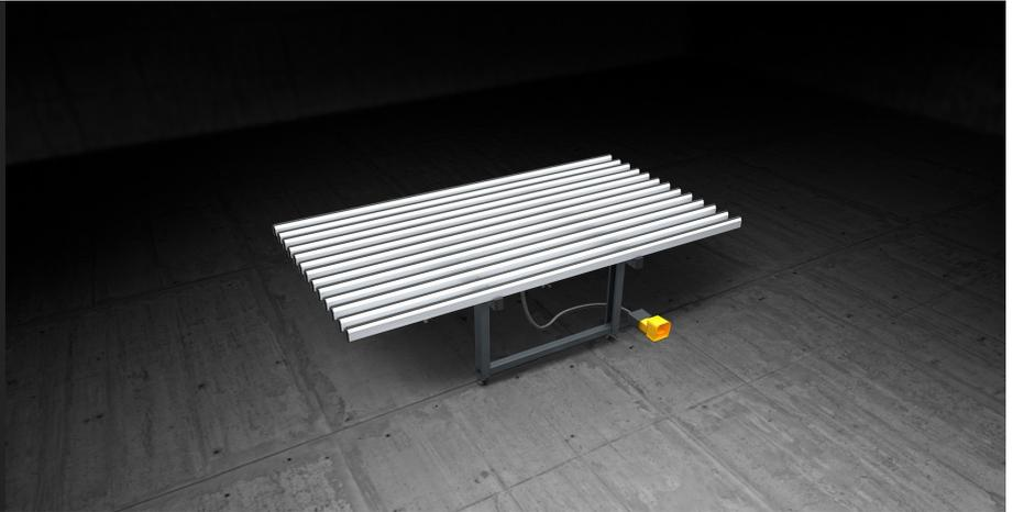
用于窗板和窗框组装的工作台。水平工作台在软质的 PVC 支撑面（用于组装阶段）和抗摩擦的硬质 PVC 支撑面（用于搬运阶段）之间有气动交换装置。工作台的高度可在 895 至 965 毫米之间调整，支脚设有地面固定孔。
