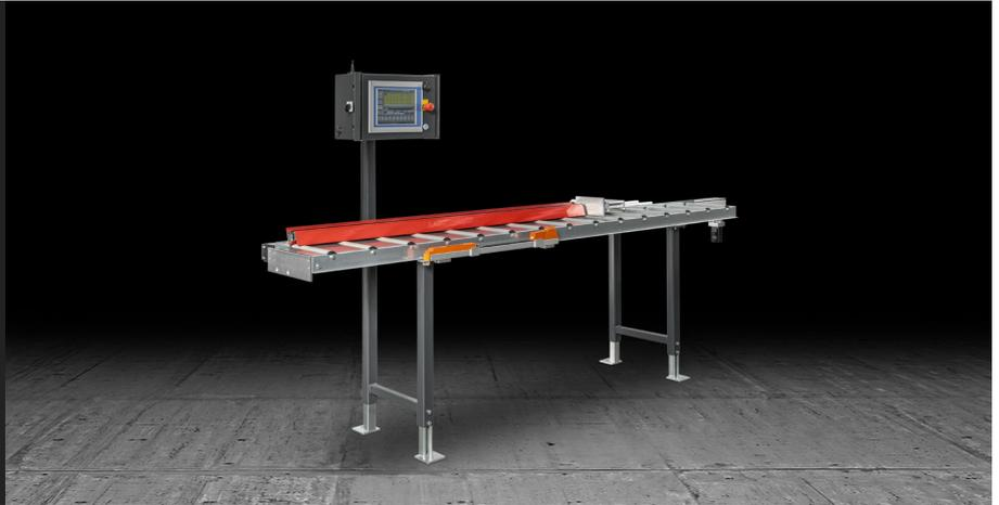
测量反馈和型材支撑系统配有止动件在数控轴上的移动装置、以及通过编码器进行读数的电子读数装置。配有电子测量系统、可以将数据保存在内存当中、或者通过蓝牙将数据实时传输到电脑或切割机的控制单元中。可以实现加工定位的高精度和可重复性。
