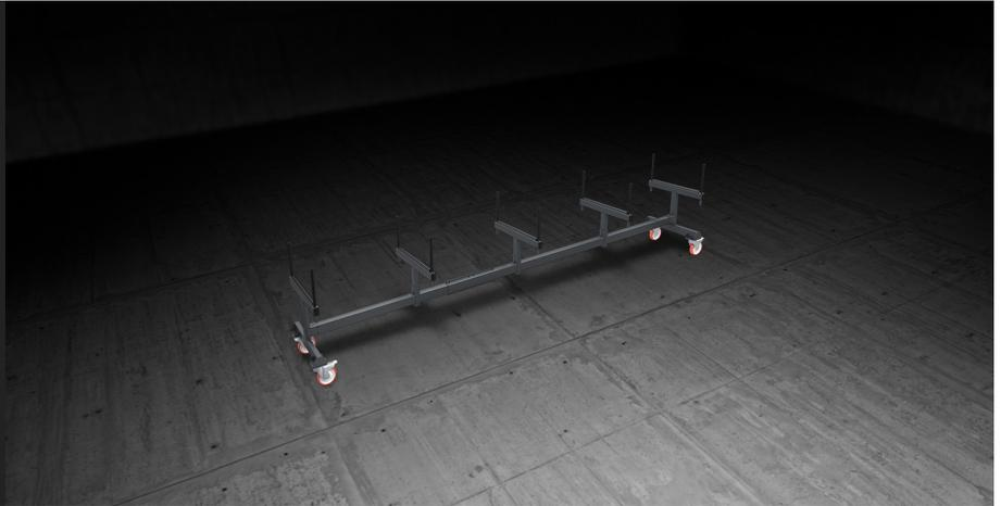
大型滑架设计用于切割阶段型材棒的运输和存放。
