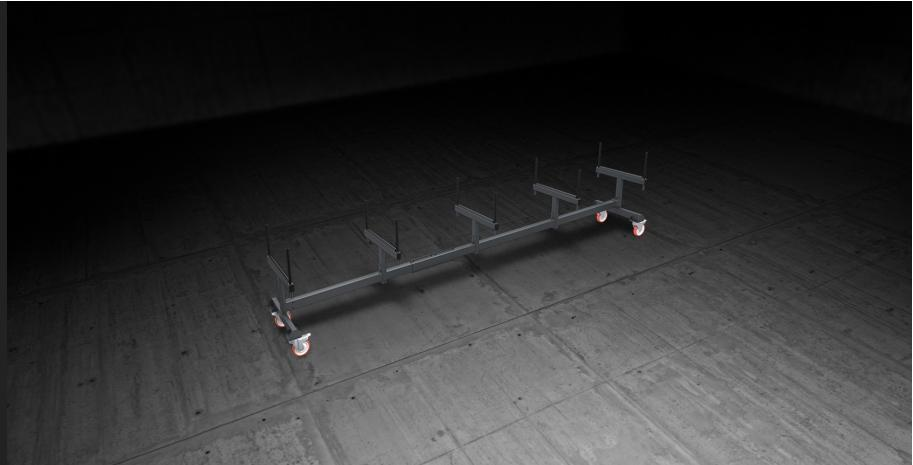
大型滑架设计用于切割阶段型材棒的运输和存放。
