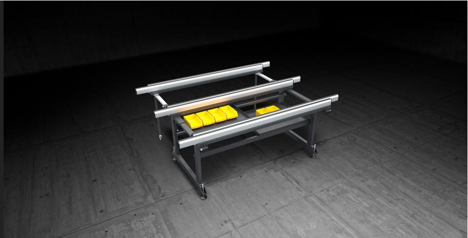
工作台适用于所有框架的组装操作。可扩展的滑动工作台可以在绝对安全的情况下加工各种尺寸的框架和非常大的结构。
