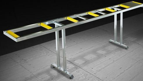
管状钢结构，带有可调节的支脚：使用 240 毫米的辊筒，辊筒输送机长度为 3.500 毫米；使用 440 毫米的辊筒，辊筒输送机长度为 4.000 毫米。
