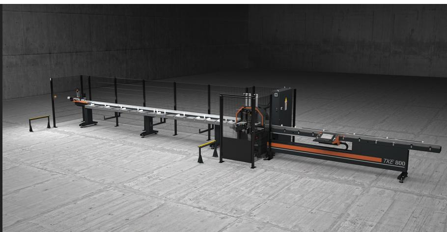
Centro de corte em versão semiautomática com 2 eixos controlados, carga/descarga manual em lados opostos da máquina, com disco de corte frontal em CNC específico para o corte de perfis em alumínio, PVC e ligas leves em geral. Efetua automaticamente as listas de corte predefinidas e otimizadas. Previsto para efetuar cortes com ângulos de 45° a 135° ou de 22°30' a 157°30'. Configurável com unidade de perfuração horizontal ou vertical personalizável para usinagens automáticas específicas.
