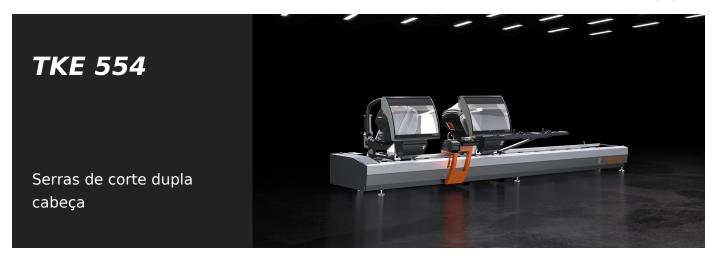
Máquina de corte de cabeça dupla de 3 eixos controlados com movimento automático da cabeça móvel e gestão eletrónica de todos os ângulos, inclusive no intervalo de 22°30' externos e 45° internos. O avanço das duas lâminas de 550 mm ocorre por meio de cilindros óleo-pneumáticos.
