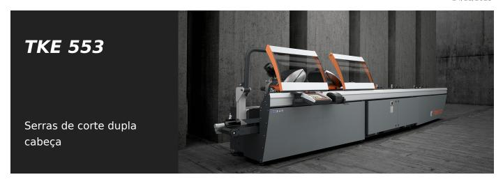
Máquina de corte com cabeça dupla de 3 eixos controlados com movimento automático da cabeça móvel e gestão eletrónica de todos os ângulos de 45° (interiores) a 15° (exteriores) com uma precisão, no interior de cada grau, de 280 posições. O avanço da lâmina é acionado por um par de cilindros óleo-pneumáticos.
