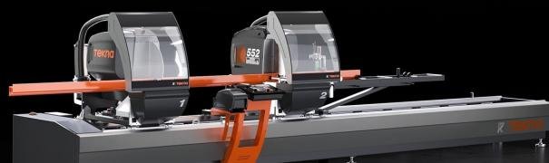
Máquina de corte com cabeça dupla eletrónica e com movimento automático da cabeça móvel através de motor brushless comandado por controlo numérico. Inclinação pneumática das unidades de corte de 90° até 22°30' (externa) em duas posições fixas ou com sistema opcional mecânico de regulação dos ângulos intermediários. Avanço óleo-pneumático do disco de corte.
