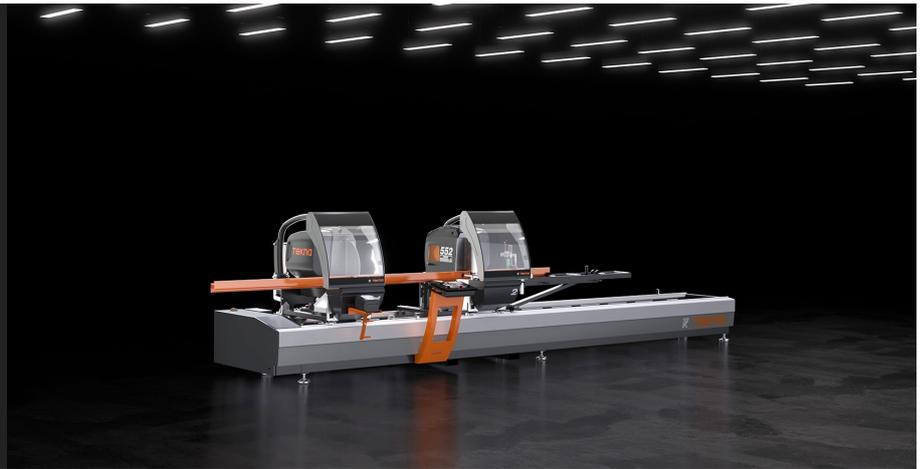
Máquina de corte com cabeça dupla eletrónica e com movimento automático da cabeça móvel através de motor brushless comandado por controlo numérico. Inclinação pneumática das unidades de corte de 90° até 22°30' (externa) em duas posições fixas ou com sistema opcional mecânico de regulação dos ângulos intermediários. Avanço óleo-pneumático do disco de corte.
