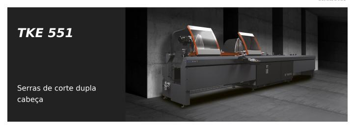
Máquina de corte com cabeça dupla eletrónica e com movimento automático da cabeça móvel através de motor brushless comandado por controlo numérico. Inclinação pneumática das unidades de corte de 90° até 22°30′ (externa) com sistema mecânico de regulação dos ângulos intermédios. Avanço óleo-pneumático do disco de cort
