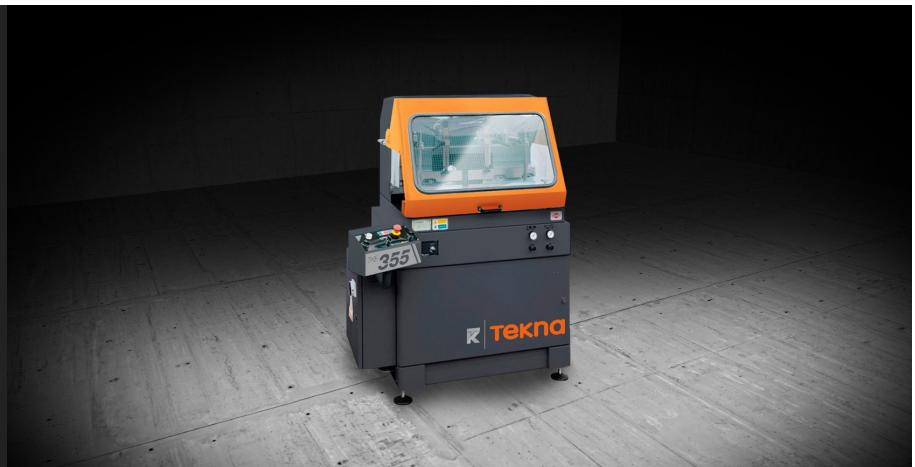
Máquina de corte monocabeça ascendente, com lado de carga à esquerda, para ângulos de corte de 20° à esquerda a 20° à direita e ângulos intermediários.
