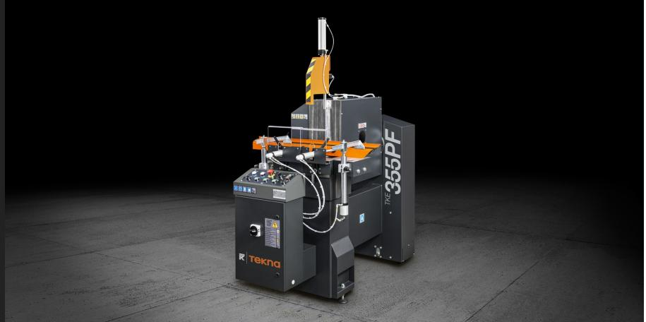
Máquina de corte de cabeça única com lâmina frontal, lado de carga à esquerda e basculamento duplo lateral de comando pneumático em posições fixas: 45° esquerda e 90°, 45° e 22°30' direita. Uma trava mecânica específica também permite o corte em ângulos intermediários.
