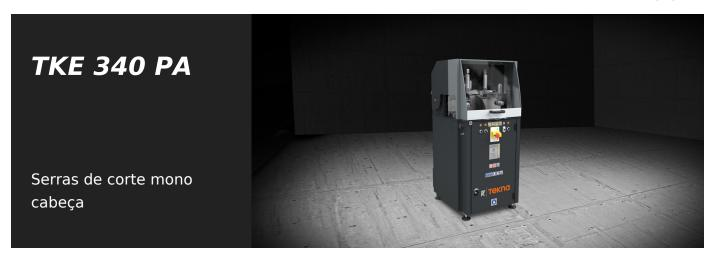
Máquina de corte monocabeça com disco de corte ascendente e lado de carga à esquerda, prevista para ângulos de corte de 15° à esquerda a 15° à direita e ângulos intermediários.
