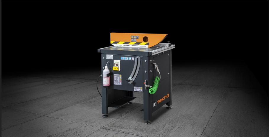
Refiladora de cabeça única com saída da lâmina ascendente, para perfis extrudados e chapas planas de alumínio. A estrutura particularmente robusta permite obter um corte bem definido e preciso que torna as faces dos perfis perfeitamente paralelas. Também está predisposta para ser equipada com lâminas de apoio que ampliam a sua versatilidade. A proteção da lâmina é estudada e realizada para trabalhar nas melhores condições de segurança.
