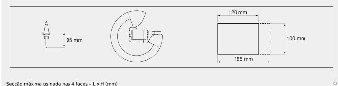
Secção máxima usinada nas 4 faces - L x H (mm)
