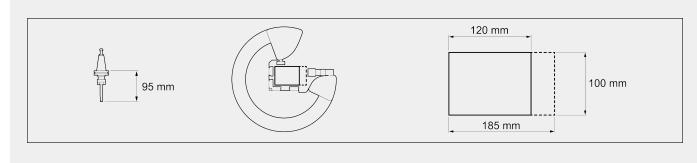
Secção máxima usinada nas 4 faces - L x H (mm)
