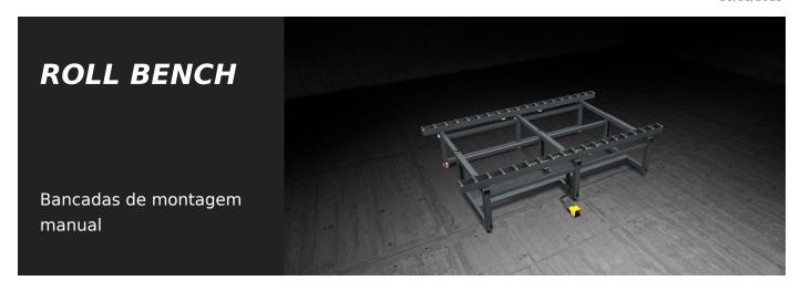
Bancada modular de grandes dimensões, dedicada à ensamblagem e à movimentação em linha de células de fachada. Está implementada com 2 pistas de roletes revestidos com uma bainha de PVC macio; a distância entre as duas pistas é regulável de acordo com a amplitude da esquadria. Um sistema por acionamento pneumático permite bloquear os roletes durante as fases de usinagem.
