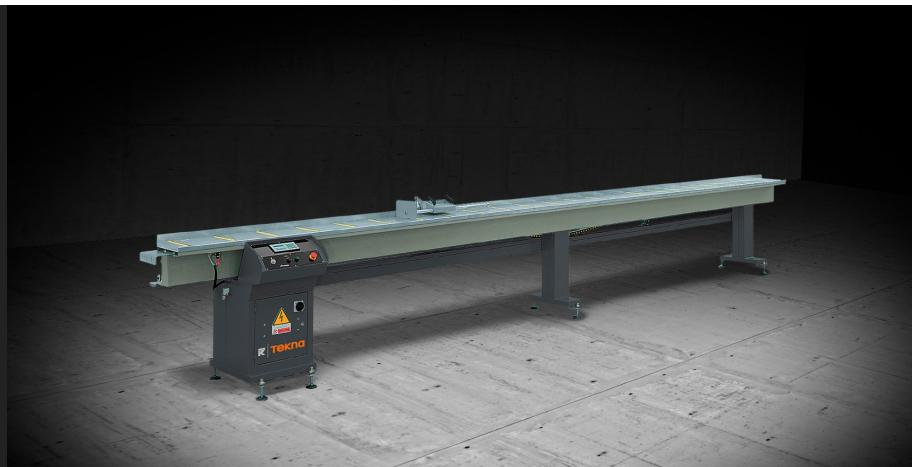
Sistema de referência da medida e suporte do perfil com movimento do encosto mediante motor de C.C. e leitura eletrônica por meio de encoder.
