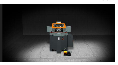
A máquina possui duas cabeças operadoras particulares equipadas com massas nas quais as 2 lâminas são reguláveis em todas as posições de chanfradura. As lâminas deslocam-se e são reguladas no eixo Y (ao longo do perfil), no eixo Z (altobaixo) e no eixo X (ao longo da direção de chanfradura). Estas condições evitam a substituição das ferramentas na máquina, independentemente dos diferentes tipos de perfil. Desta forma, os tempos e os custos de colocação são reduzidos.
