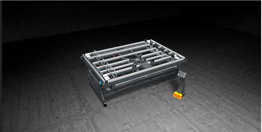
Bancada dedicada à ensamblagem do quadro de alumínio com a junta e o vidro. Mediante uma cruzeta o vidro é levantado e graças a um sistema de morsas com autoalinhamento os quadros são prensados dois a dois. Uma vez concluída a prensagem dos primeiros dois lados, faz-se girar a cruzeta e é possível prensar os outros dois lados.
