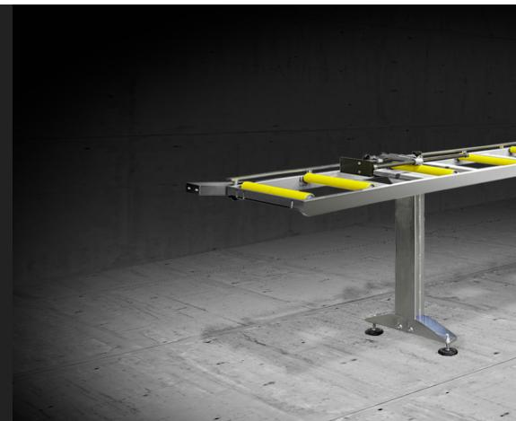
Estrutura em tubular de aço com pés ajustáveis e rolos de aço revestidos com PVC. Rolos de 240 mm., com comprimento da bancada de rolos de 3.500 mm., ou rolos de 440 mm. com comprimento da bancada de rolos de 4.000 mm.
