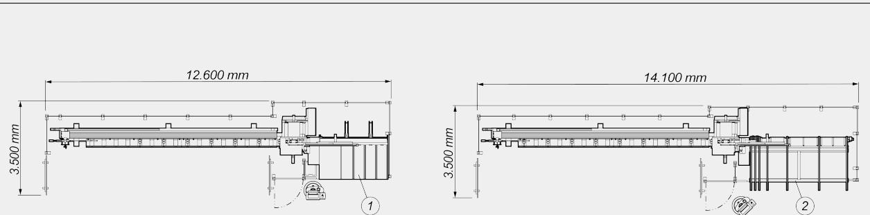
1. Magazzino di scarico con estrattore automatico (standard)
