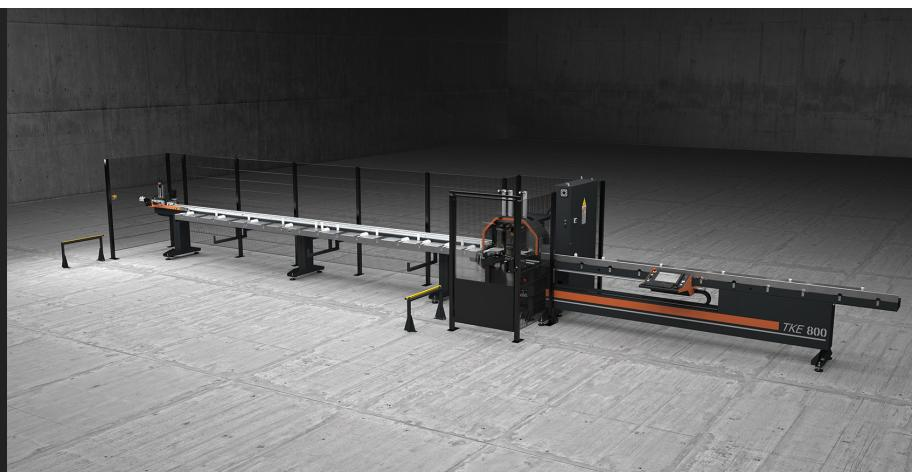
Centro di taglio in versione semiautomatica con 2 assi controllati, carico/scarico manuale sui lati opposti della macchina, con lama frontale a CNC, dedicato al taglio di profili in alluminio, PVC e leghe leggere in genere. Esegue in automatico liste di taglio predefinite ed ottimizzate. Previsto per eseguire tagli con angolazioni da 45° a 135° oppure da 22°30' a 157°30'. Configurabile con unità di foratura orizzontali o verticali personalizzabili per lavorazioni automatiche specifiche.
