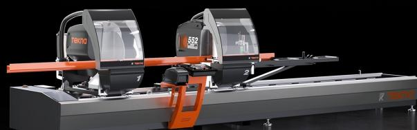
Troncatrice doppiatesta elettronica con movimento automatico della testa mobile tramite motore brushless comandato da un controllo numerico. Inclinazione pneumatica delle unità di taglio da 90° fino a 22°30' (esterna) in due posizioni fisse oppure con sistema opzionale meccanico di regolazione delle angolazioni intermedie. Avanzamento lama oleopneumatico.
