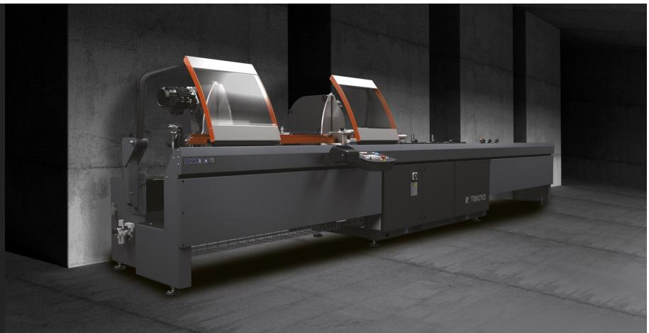
Troncatrice doppiatesta elettronica con movimento automatico della testa mobile tramite motore brushless comandato da un controllo numerico. Inclinazione pneumatica delle unità di taglio da 90° fino a 22°30' (esterna) con sistema meccanico di regolazione delle angolazioni intermedie. Avanzamento lama oleo-pneumatico.
