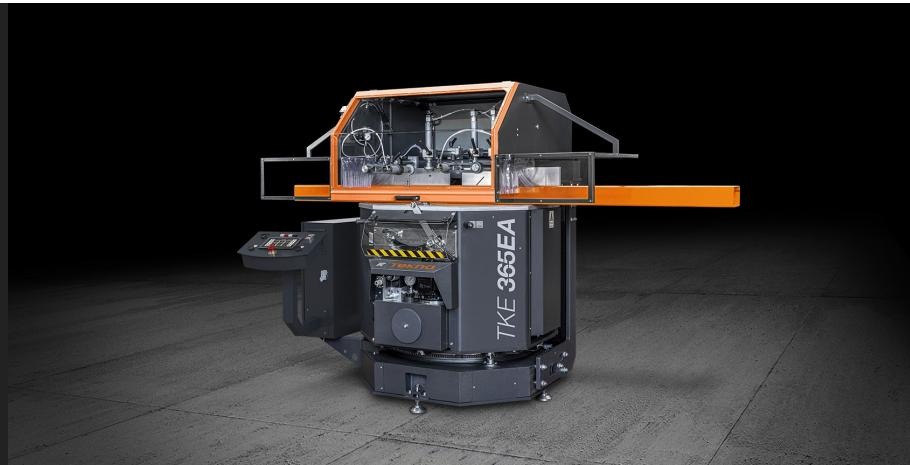
Troncatrice monotesta ascendente con rotazione automatica a controllo numerico dell'asse verticale mediante motore brushless e contemporaneo ribaltamento a comando idraulico dell'asse orizzontale. Tagli con angolazioni da 90° a 22°30' (sinistra e destra) sull'asse verticale e da 90° a 35° (solo a destra) sull'asse orizzontale.
