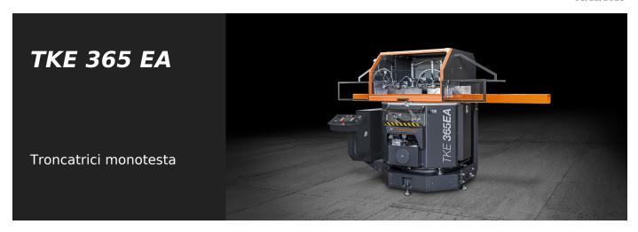
Troncatrice monotesta ascendente con rotazione automatica a controllo numerico dell'asse verticale mediante motore brushless e contemporaneo ribaltamento a comando idraulico dell'asse orizzontale. Tagli con angolazioni da 90° a 22°30′ (sinistra e destra) sull'asse verticale e da 90° a 35° (solo a destra) sull'asse orizzontale.
