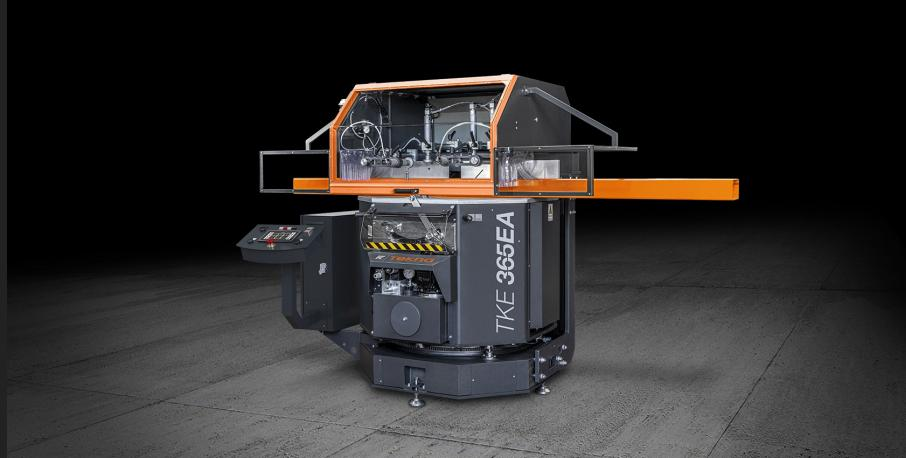
Troncatrice monotesta ascendente con rotazione automatica a controllo numerico dell'asse verticale mediante motore brushless e contemporaneo ribaltamento a comando idraulico dell'asse orizzontale. Tagli con angolazioni da 90° a 22°30' (sinistra e destra) sull'asse verticale e da 90° a 35° (solo a destra) sull'asse orizzontale.
