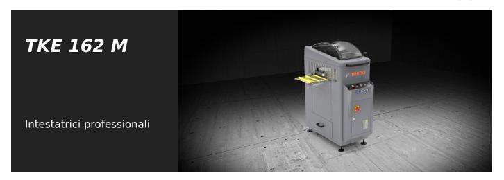
Intestatrice orizzontale ad avanzamento manuale. Fresatura fuori squadro +45° / 90° / -45°. Alta velocità di rotazione utensile per migliorare la qualità della lavorazione sul profilato verniciato e fuori squadro. Cambio rapido del gruppo frese con comando pneumatico. Piano di lavoro antigraffio. Zona lavoro integralmente carenata ad ampia visibilità interna.
