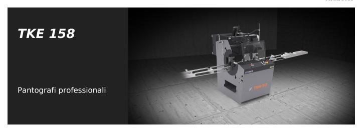
Pantografo monotesta a comando manuale con bloccaggio pneumatico e movimento di traslazione testa attraverso leva indiretta. Velocità di rotazione utensile modificabile con variatore elettronico per permettere le lavorazioni su acciaio fino a 2 mm, e per migliorare la qualità delle fresature e la durata dell'utensile. Possibilità di eseguire lavorazioni passanti su alluminio senza girare il pezzo. Piano di lavoro antigraffio. Tastatore a comando manuale.
