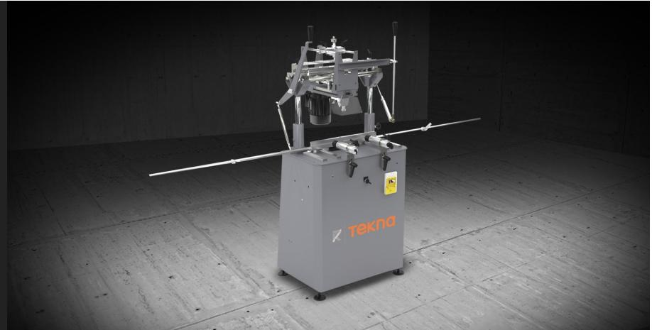
Pantografo monotesta a comando manuale con ampia corsa in altezza e movimento di traslazione testa con impugnatura o leva indiretta. Possibilità di eseguire lavorazioni passanti senza girare il pezzo. Tastatore a comando manuale.
