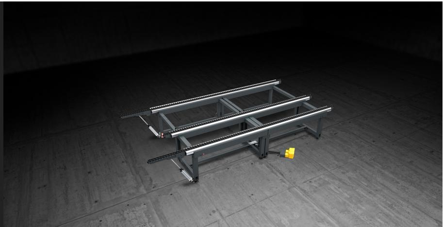
Banco modulare di grandi dimensioni, estensibile, dedicato all'assemblaggio di serramenti e celle di facciata. È corredato di 3 piani di lavoro distinti: uno con PVC morbido per le operazioni di assemblaggio, uno con PVC duro antifrizione per la rotazione ed una rulliera per lo spostamento in linea.
