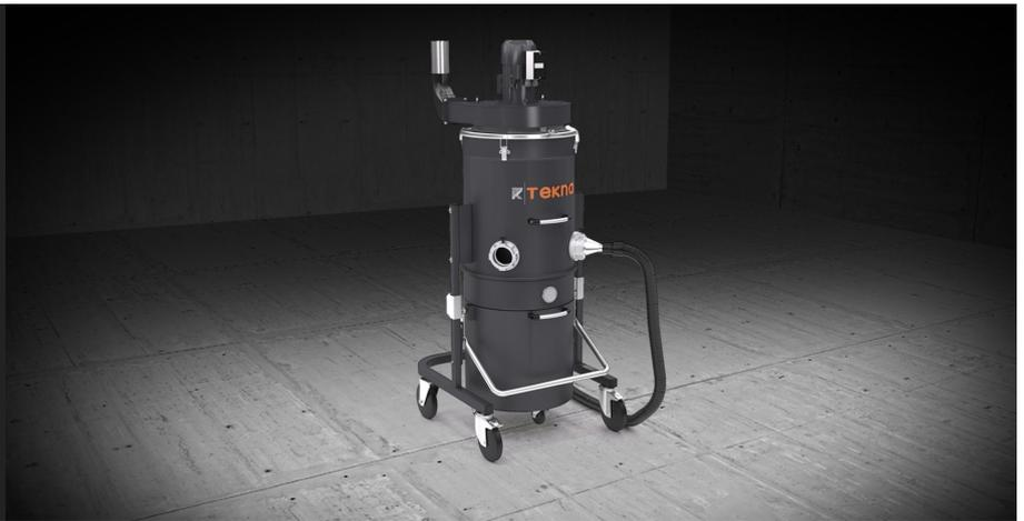
Sistema di aspirazione trucioli dalle unità di lavoro, con alimentazione autonoma e start automatico dalla macchina. Ideale per alluminio e PVC. L'utilizzo di una ventola di grande portata, lo rende idoneo alle diverse esigenze di aspirazione. Sistema automatico vibrante di pulizia del filtro e serbatoio di raccolta a sgancio rapido montato su ruote, per il semplice e rapido smaltimento del materiale aspirato.
